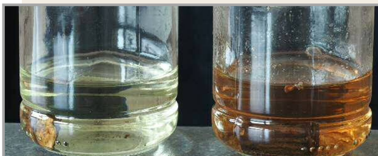
Fig. 1. Links: zuivere glaswand bij loofhout; rechts: troebele glaswand bij naaldhout
